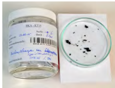
Lichtbild 7: abgekratzte Brandschuttantragungen vom Kanisterdeckel
