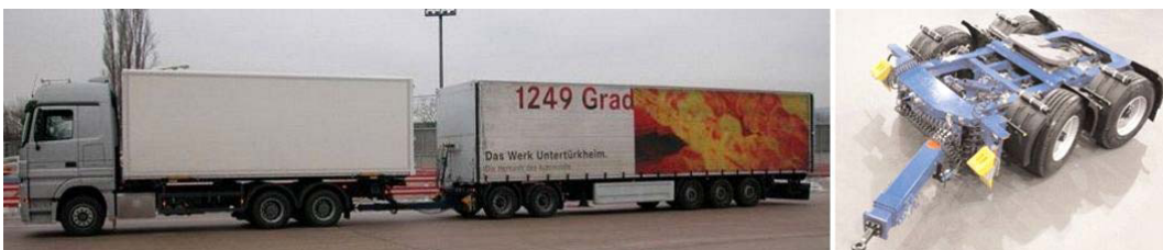
3-Achs-Sattelaufleger, Fa. Keppler, Typ SA 24 L (E KEP V 1), 3. Achse als Lenkachse (offen) Kombination mit Lenk-Dolly tiefgekuppelt ACTROS 2660 LL / 6x4/ 4500 (L 930 V 117) 2-Achs-Dolly, Fa. Krone, Typ ZZB 18 (E KNW V 21), tiefgekuppelt, lenkbar 3-Achs-Sattelaufleger, Fa. Keppler, Typ SA 24 L (E KEP V 1), 3. Achse als Lenkachse (offen)
