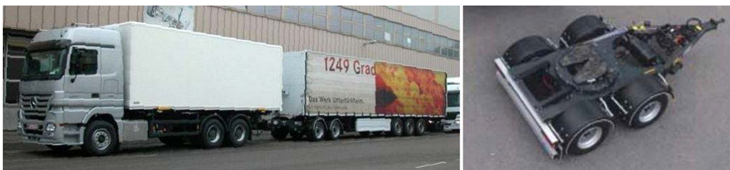
Kombination mit starrem Dolly hochgekuppelt ACTROS 2660 LL / 6x4/ 4500 (L 930 V 117) 2-Achs-Dolly, Fa. Närke, Typ C2MS11P11 (H NAE V1), hochgekuppelt
