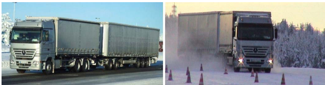
ACTROS 2660 LL / 6x4/ 4500 (L 930 V 117) 2-Achs-Dolly, Fa. Doll, Typ ZD 119, hochgekuppelt 3-Achs-Sattelauflieger, Fa. Krone, Typ SDP 27 (E KNW V 11)
